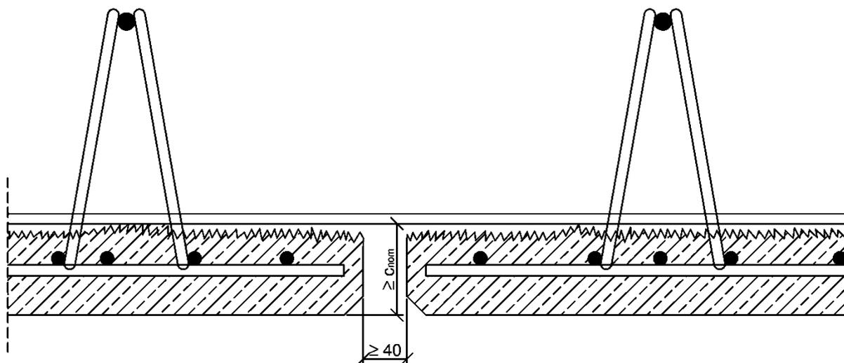
Für die Betondeckung im Ortbeton ist Abschnitt 3 der Zulassung zu beachten.
