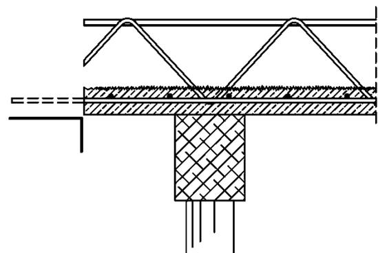
Auflagerung ohne Montageunterstützung am Rand, wenn  $a \geq 35\text{mm}$  ist und die Bedingungen nach Abschnitt 3.2.2 erfüllt sind.
