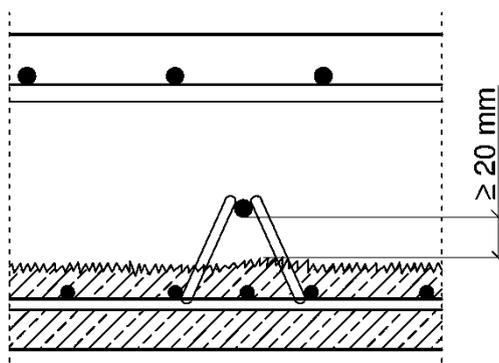
**Bild 8: Gitterträger als Verbund- und Querkraftbewehrung (mäßige Beanspruchung)**
