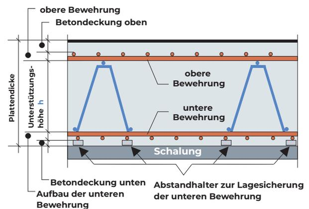
In Abhängigkeit von der Art der Unterstützung, d. h. linienförmige oder punktförmige Unterstützung, werden im Merkblatt die zulässigen Belastungen und die Verlegeabstände definiert.
