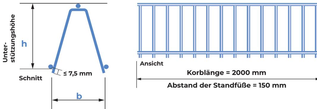
**BT-Körbe** stehen auf der unteren Bewehrung und garantieren daher die Unversehrtheit des Untergrundes (Schalung). Sie können somit auch in Bauteilen eingesetzt werden, die besondere Anforderungen an die Betonoberfläche stellen (z. B. Ausführung der Deckenunterschicht in Sichtbetonqualität).
