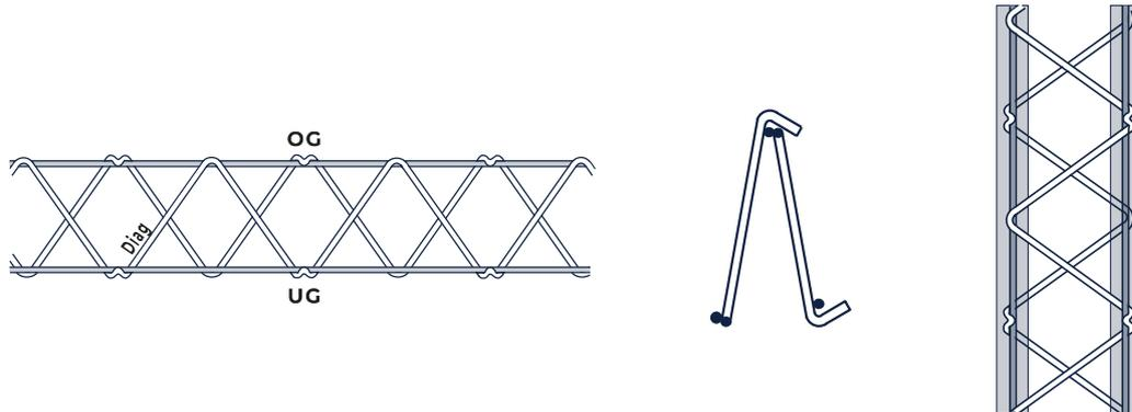
Beim KTW 200-Gitterträger wird die Trägerhöhe mit den letzten beiden Ziffern angegeben.
