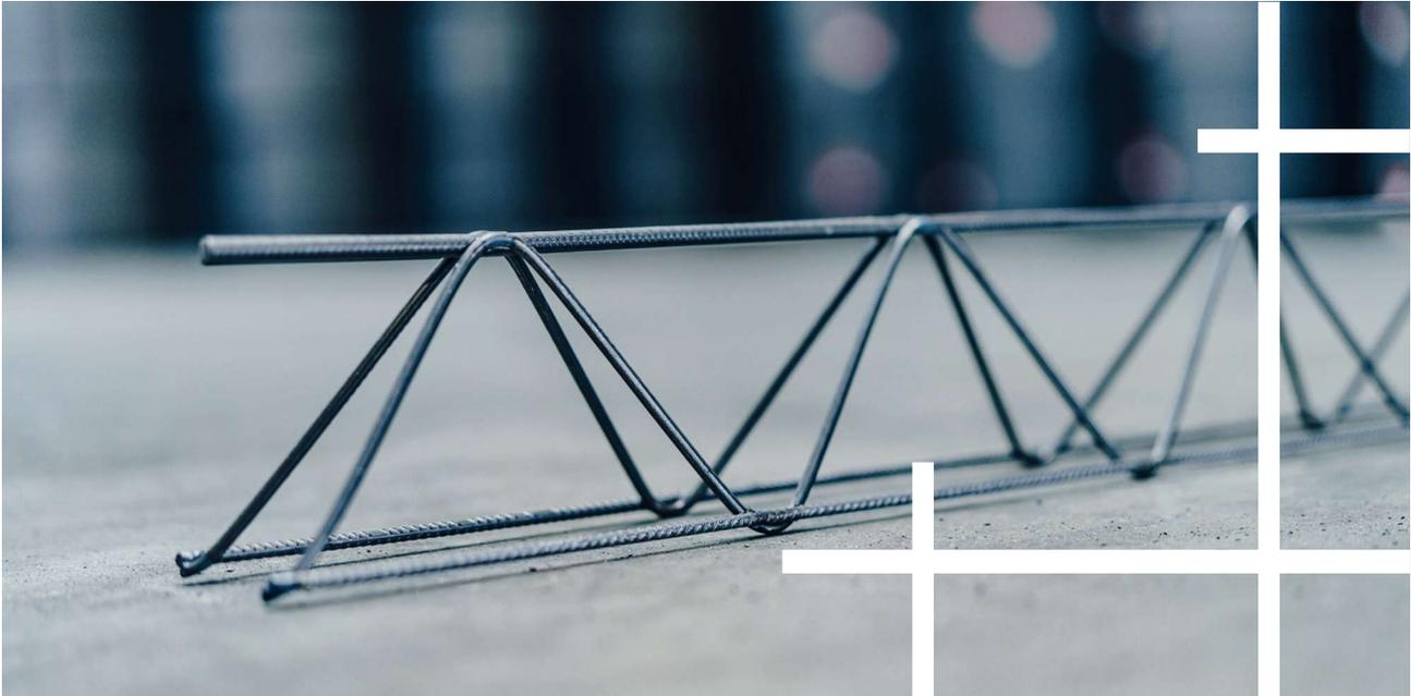
Gitterträger sind werksmäßig vorgefertigte Bewehrungselemente nach Zulassung. Sie bestehen aus einem Obergurt (OG), einem oder mehreren Untergurt(en) (UG) und durchgehenden oder unterbrochenen Diagonalen (Diag). Die Diagonalen werden durch Widerstandspunktschweißungen mit den Gurten verbunden. Sie werden aus glatten, profilierten oder gerippten Stählen hergestellt.
