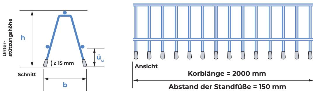
**BK-Körbe** stehen auf der Schalung oder Sauberkeitsschicht. Sie werden daher in Bauteilen eingesetzt, die keine besonderen Anforderungen an die Betonoberfläche stellen und eine Beschädigung des Untergrundes (Aufstandsfläche) durch Eindrücken oder Durchstanzen ausgeschlossen werden kann (z. B. Folien unter Bodenplatten).
