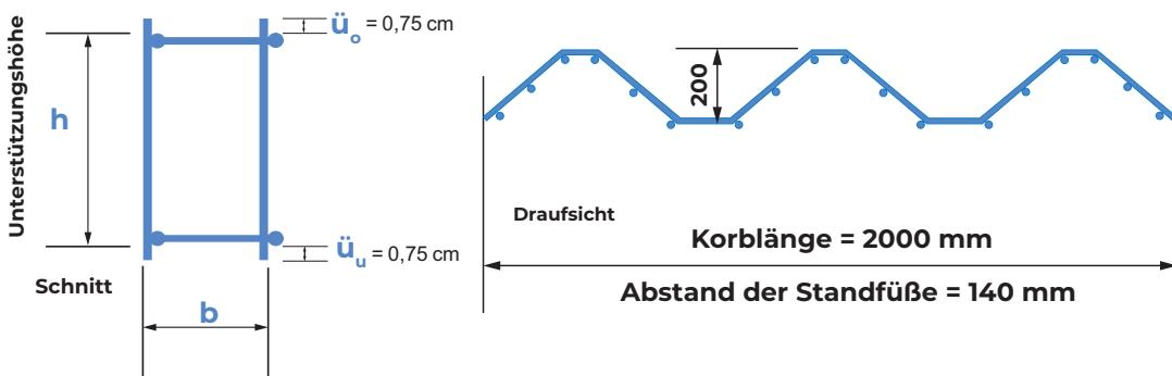
**BS-Körbe** stehen auf der unteren Bewehrung und garantieren daher die Unversehrtheit des Untergrundes (Schalung). Sie können somit auch in Bauteilen eingesetzt werden, die besondere Anforderungen an die Betonoberfläche stellen (z. B. Ausführung der Deckenunterschicht in Sichtbetonqualität).
